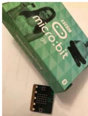
Bereits im letzten Schuljahr wurden „BBC micro:bits“ an der NMS Allentsteig angekauft. Dabei handelt es sich um Einplatinencomputer, die speziell für den Programmierunterricht und das Erlernen von Programmiersprachen entwickelt wurden. Der BBC micro:bit ermöglicht zwei
